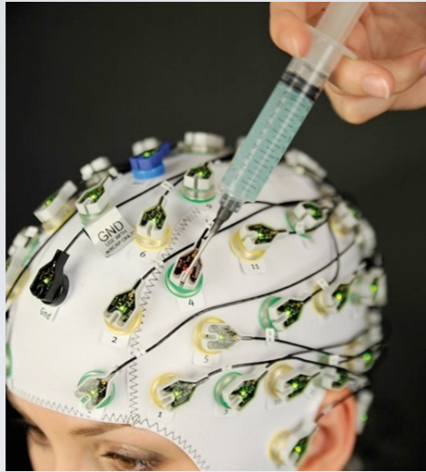
Systeme BrainAmp - ActiCap (32 électrodes)
