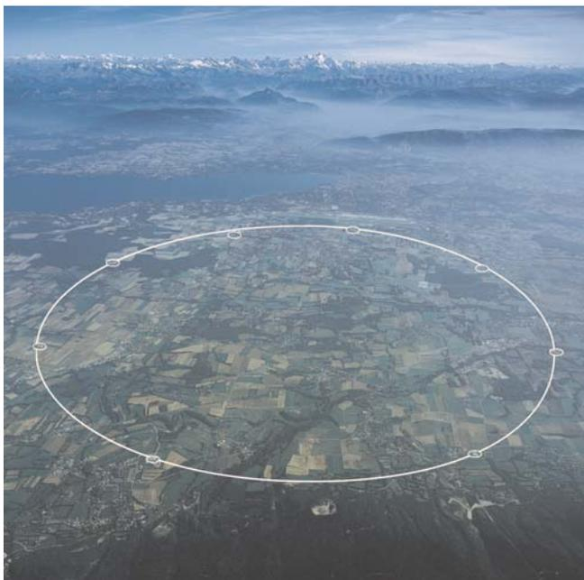
Fig. 1 : La machine LHC en rouge, à 100 m sous terre, entre l'aéroport de Genève et le Jura. Les points d'accès de la surface sont les petits cercles. Dans le fond, le lac Léman et le mont Blanc.
