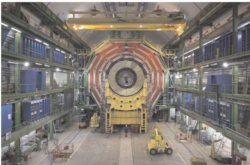
Fig. 3 : La moitié du détecteur CMS dans sa caverne (diamètre 15 m, longueur totale de CMS 21,6 m, poids total 12 500 tonnes).
