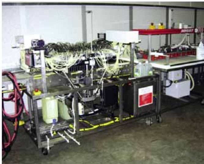
Fig.2.4: Machine permettant les injections in ovo utilisée lors du transfert de l'incubateur vers l'éclosoir.
