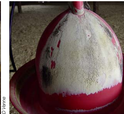
Fig.81.25: Entartrage formé sur un abreuvoir Plasson.
