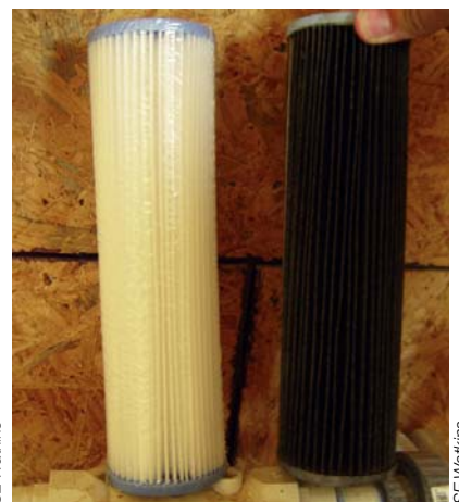
Fig.81.32: Filtro limpio y filtro tapado con hierro y manganeso.
