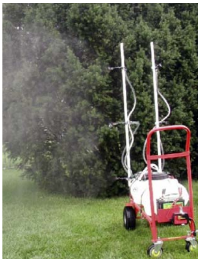
Fig.4.9: Equipo de vacunación por aspersión para caseta de crianza en jaula.
