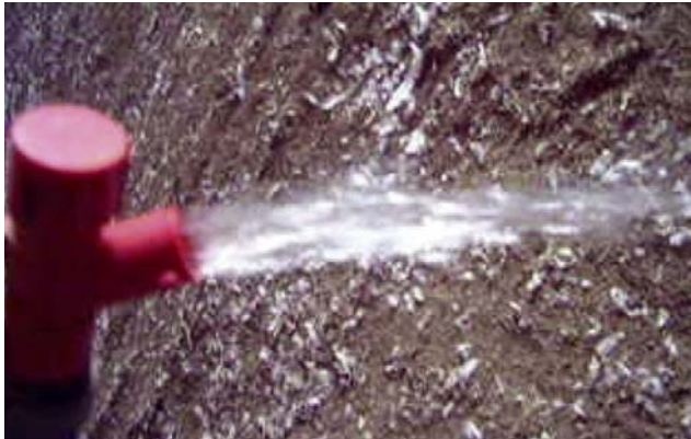
Fig.81.15 & 81.16: No todos los productos son eficaces para eliminar el biofilm acumulado. A la izquierda, esta línea se llenó con un ácido débil pero, con respecto a la imagen siguiente, la solución no eliminar cualquier material. En este siguiente imagen, la línea de agua se limpió con una solución al 3% de un 50% de H 2 O 2 estabilizado mucho más eficaz en la interrupción y la eliminación de material acumulado en el sistema.
