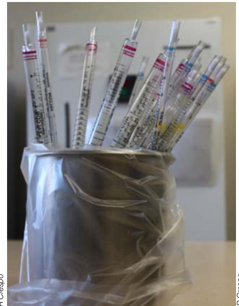
Fig.17.11: Eliminación adecuada de pipetas y material usado para evitar la contaminación de las superficies de trabajo o de las muestras.
