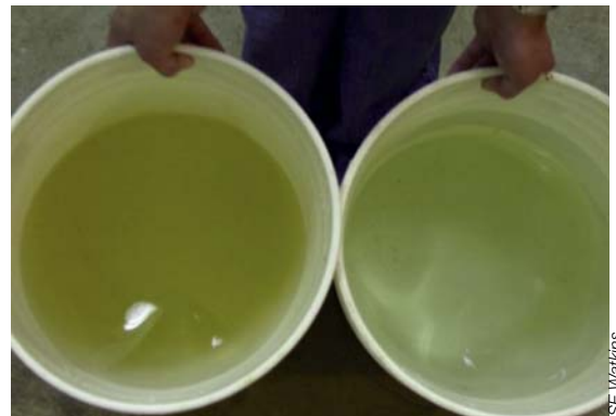
Fig.81.19: Agua antes y después de la limpieza de las tuberías.
