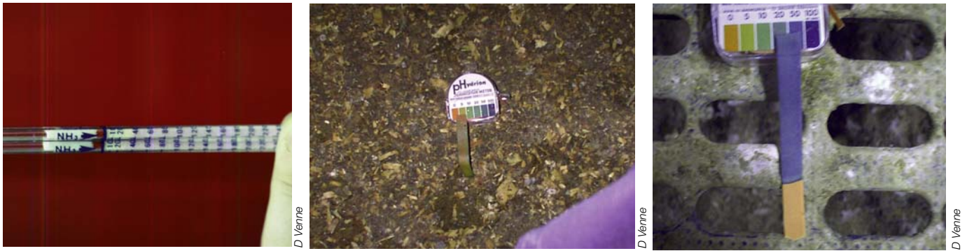
Fig.74.15, 74.16 & 74.17: Controlando niveles de amoníaco en campo.
