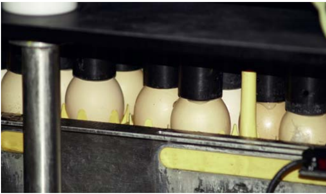
图82.7: 在把鸡胚从孵化器转移到出雏器时进行鸡胚注射免疫。
