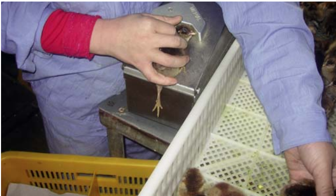
图82.11: 孵化场中用于给1日龄雏鸡做皮下注射的自动注射器。
