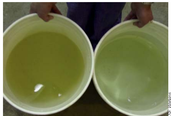
图.81.19:清洗水管前后出的水。
