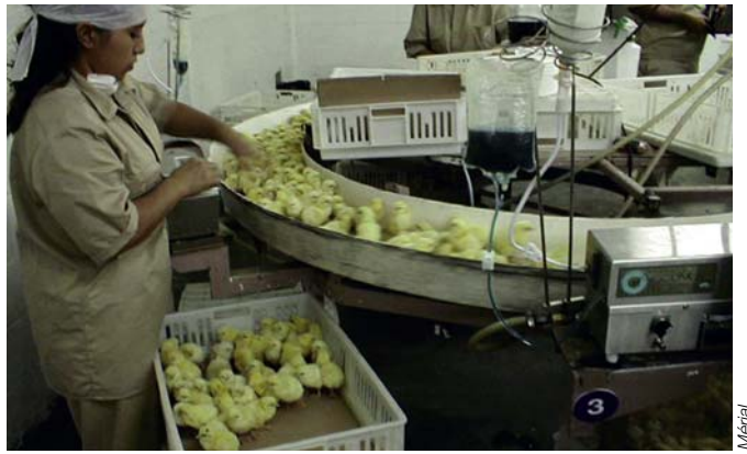
图82.10: 孵化场中用于给1日龄雏鸡做皮下注射的圆盘传送带。
