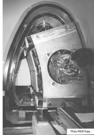
Fig. 5 : Deux secteurs du pré-échantillonneur montés en face d'un module du calorimètre électromagnétique lors des tests en faisceau au CERN.
