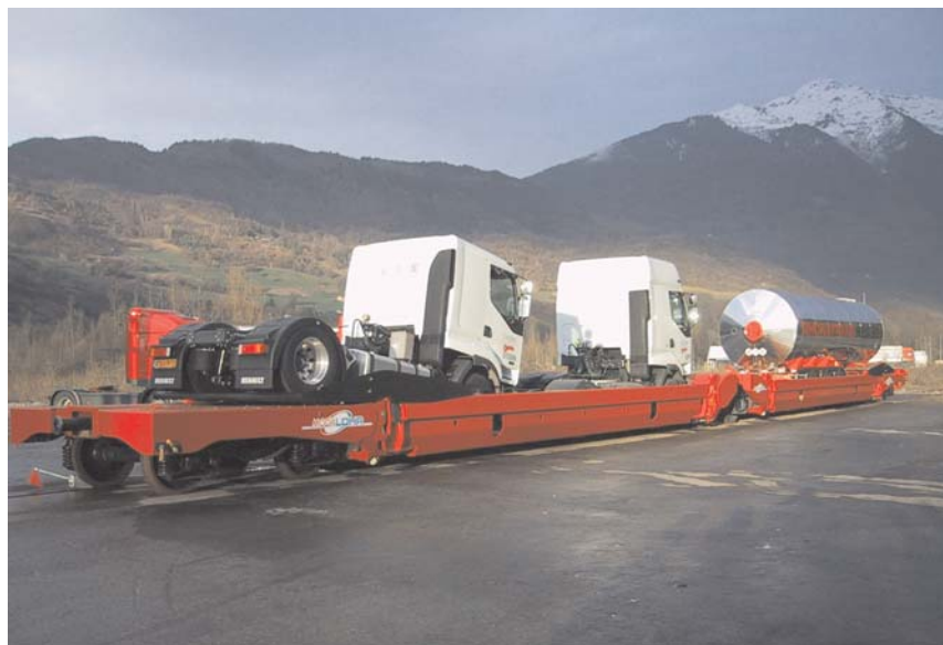
Figure 29 : Les deux premiers wagons Modalohr avec leur chargement de deux tracteurs et une citerne.
