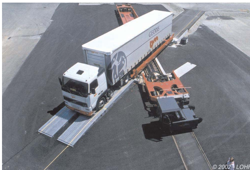
Figure 28 : Chargement d'une semi-remorque sur le premier wagon Modalohr.
